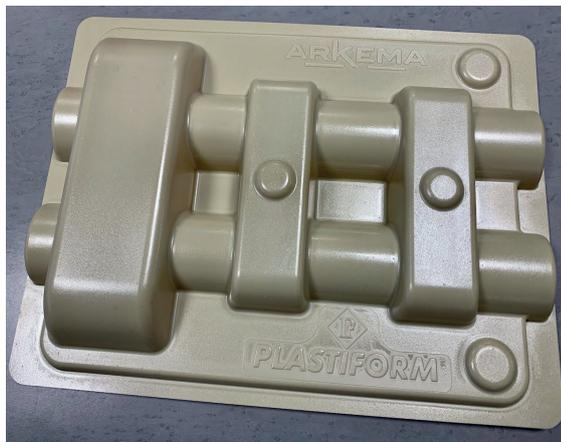
**Bild 4.** Thermogeformtes Bauteil aus teilkristallinem PEKK: Durch das entwickelte Verfahren lassen sich sehr chemikalienbeständige Bauteile mit geringeren Kosten herstellen © Arkema
